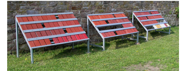
Bewitterungsstand in der Propstei Johannesberg zur Untersuchung von Anstrichsystemen für Holz im Außenbereich
